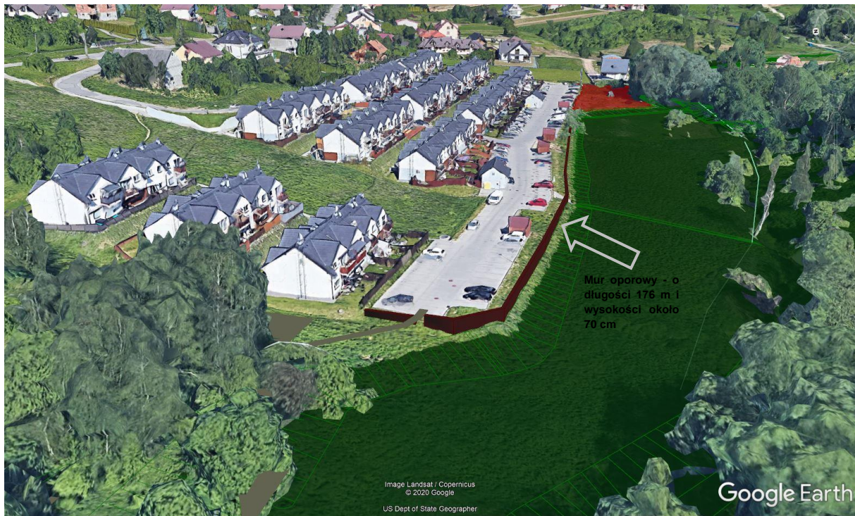
Rysunek 7. Zaprojektowany mur oporowy na prawym brzegu zbiornika
