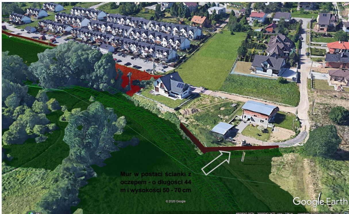
Rysunek 9. Zaprojektowany mur oporowy w obszarze cofki na prawym brzegu zbiornika
