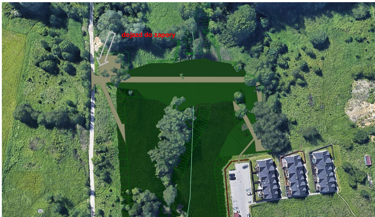
Rysunek 6. Projektowane dojazdy do zapory czołowej i zjazdy do czaszy zbiornika Malinówka 3
