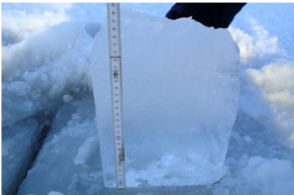
Zdjęcie 12: Pomiar grubości lodu.
