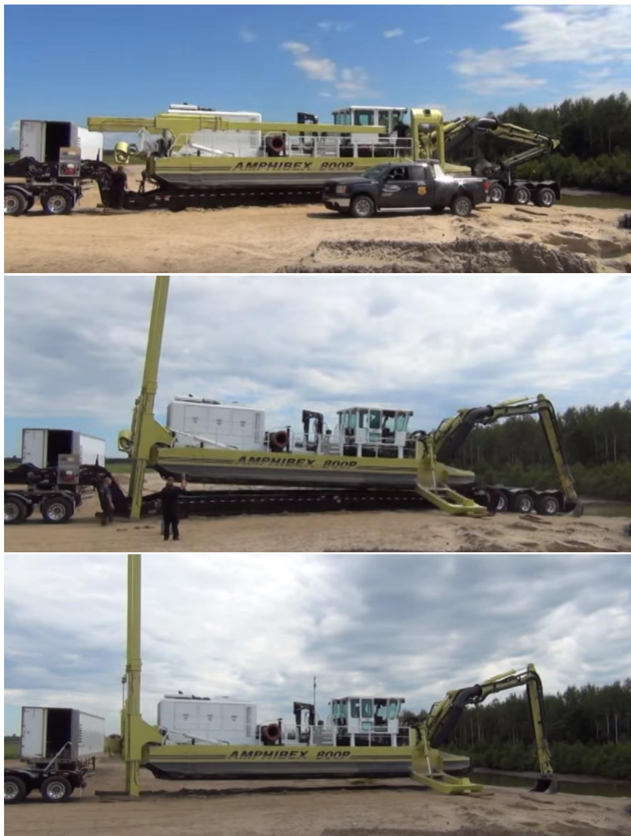
Rysunek 2. Etapy rozładunku pogłębiarki Amphibex 800 (rozwiązanie analogiczne dla Amphibex 400)
