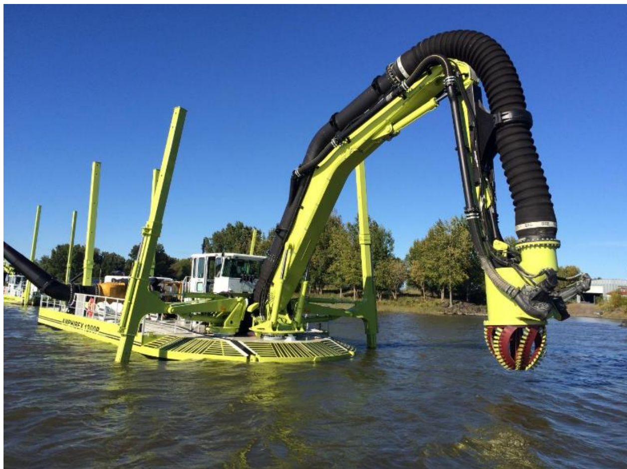
Rysunek 6. Pogłębiarka Amphibex 1200; źródło: www.normorock.ca
